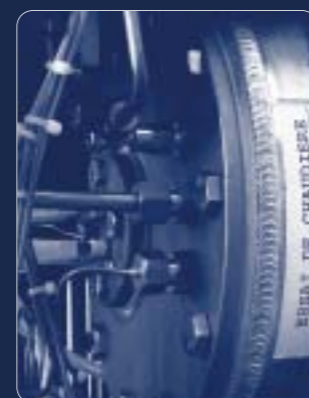
Flanc de chaudière à large ouverture. Boiler flange with a large opening. Kesselflansch mit einer großen Öffnung.
